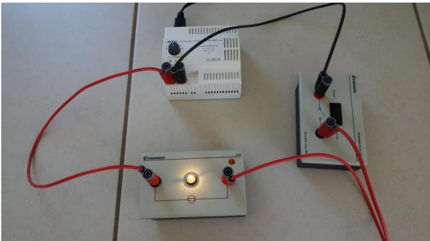
Brancher, avec deux fils supplémentaires, le voltmètre en dérivation aux bornes du dipôle.
